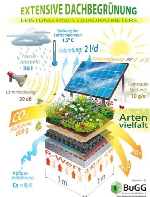
Abb. 63: Das kann ein Quadratmeter eines optimalen Solar-Gründachs leisten. Quelle: BuGG
