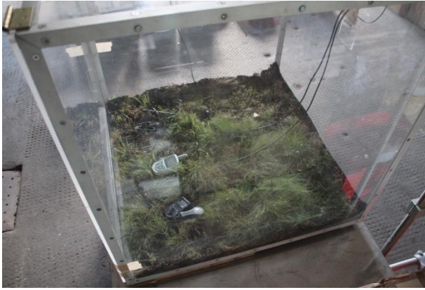
Abbildung 1 CO 2 -Messung in großer Plexiglasbox
