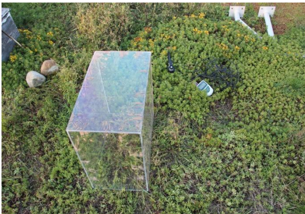
Abbildung 2 CO 2 -Messung in kleiner Plexiglasbox
