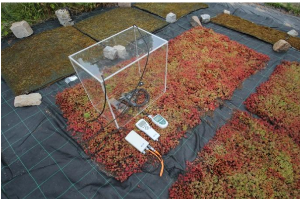
Abbildung 5 Messaufbau zur CO 2 -Messung mit einer vorkultivierten Vegetationsmatte
