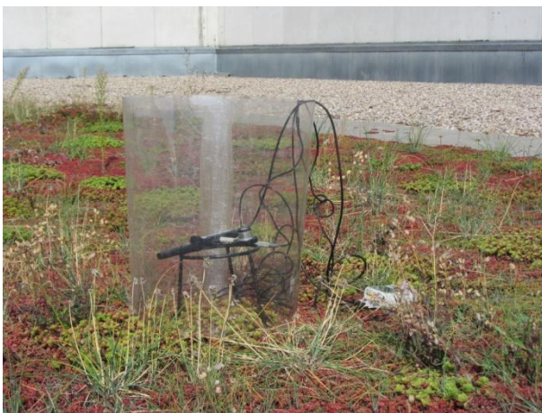
Abbildung 3 CO 2 -Messung in Plexiglaszylinder
