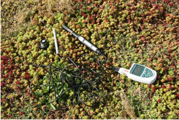
Abbildung 4 Messgeräte zur Aufnahme von CO 2 , PAR und klimarelevanten Parametern
