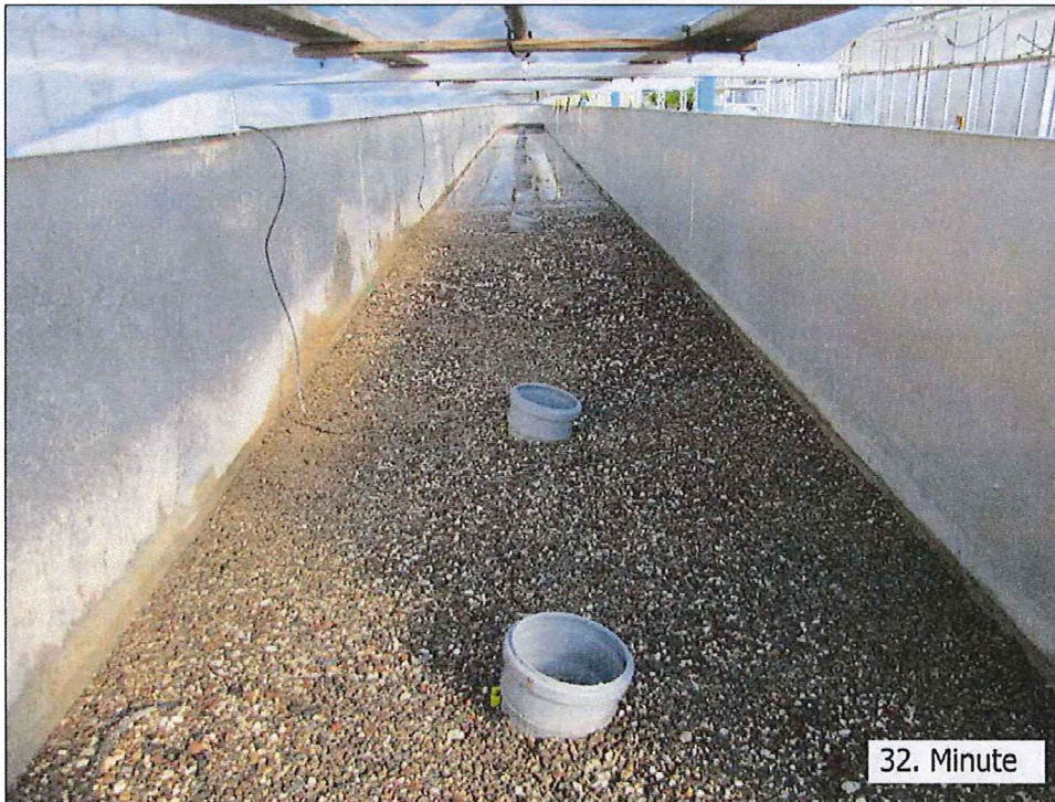
Abbildung 19: Blick in Beregnungsanlage - Ausdehnung „stehendes“ Oberflächenwasser 32. Minute
