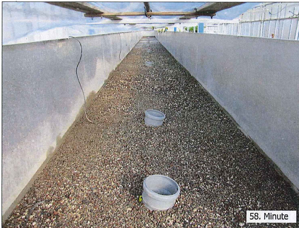
Abbildung 21: Blick in Beregnungsanlage - Ausdehnung „stehendes“ Oberflächenwasser 58. Minute
