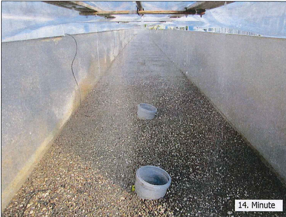
Abbildung 15: Blick in Beregnungsanlage – Ausdehnung „stehendes“ Oberflächenwasser 14. Minute
