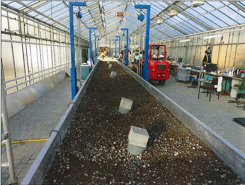
Abbildung 6: Eingebauter Schichtaufbau mit Kameramessstellen
