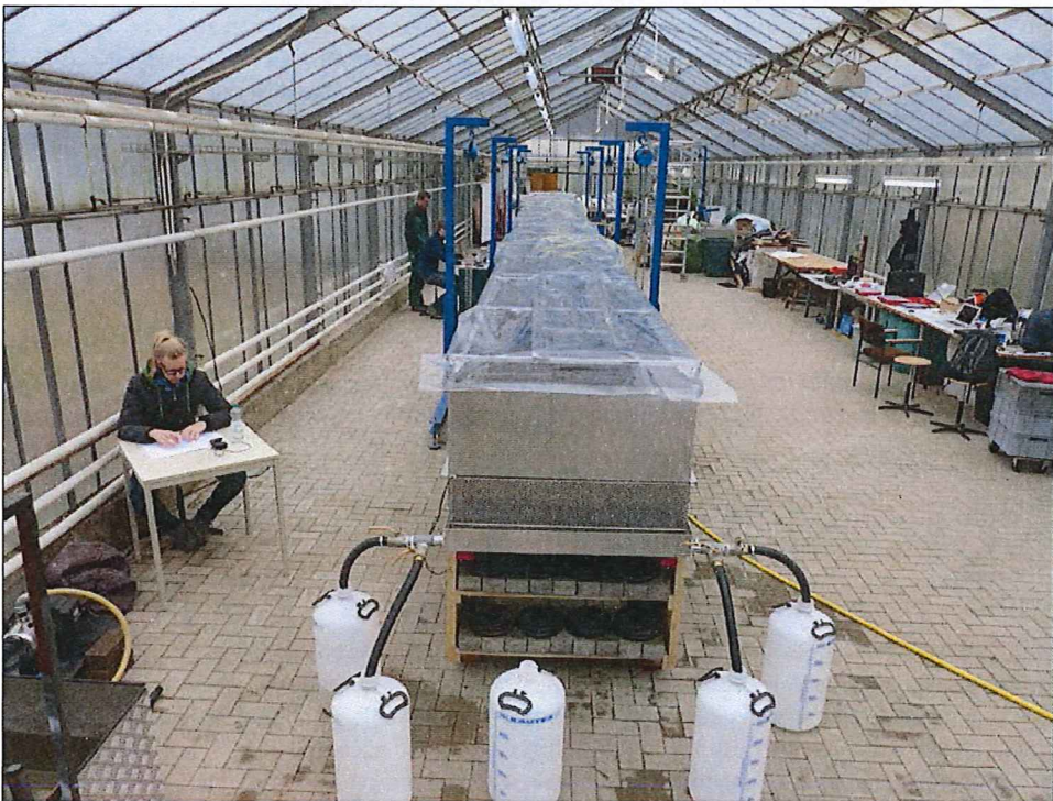
Abbildung 7: Eingehauste Versuchsanlage während der Beregnung
