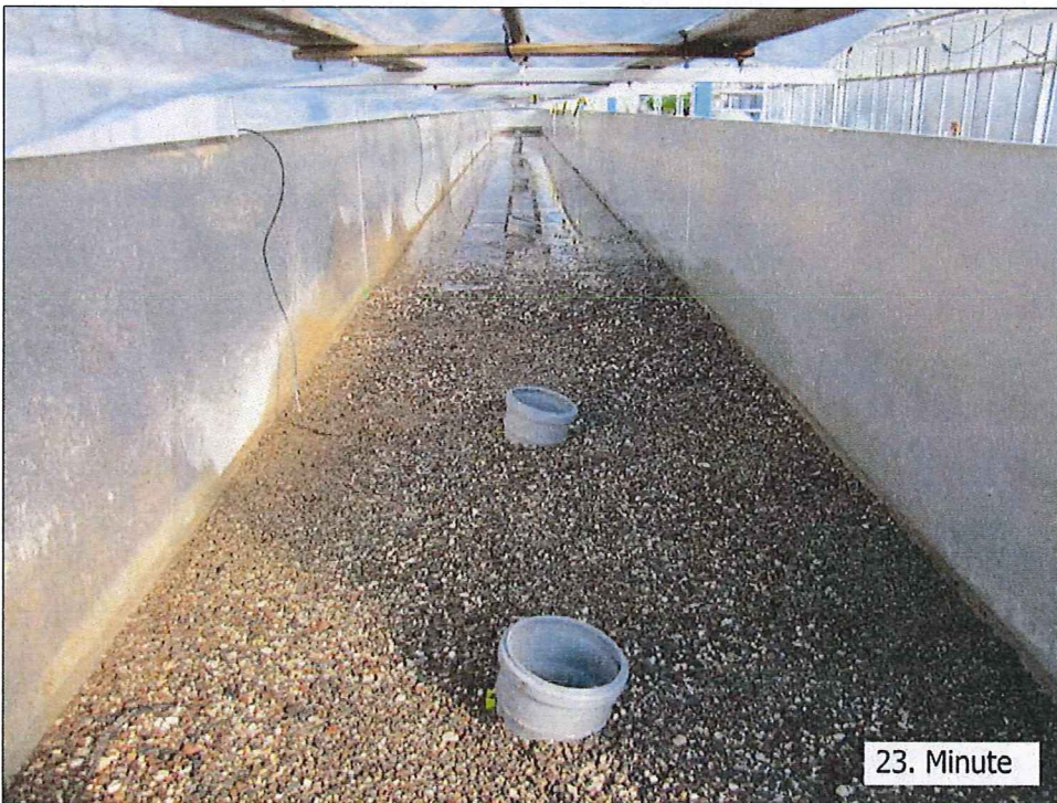
Abbildung 18: Blick in Beregnungsanlage - Ausdehnung „stehendes“ Oberflächenwasser 23. Minute
