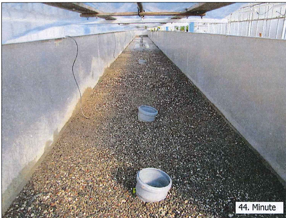
Abbildung 20: Blick in Beregnungsanlage - Ausdehnung „stehendes“ Oberflächenwasser 44. Minute
