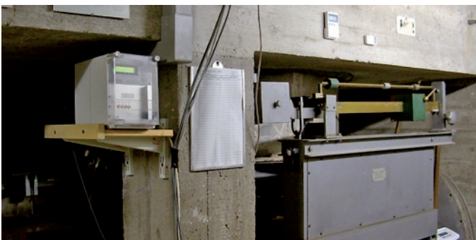
Lysimeteranlage – Waagen von unten
